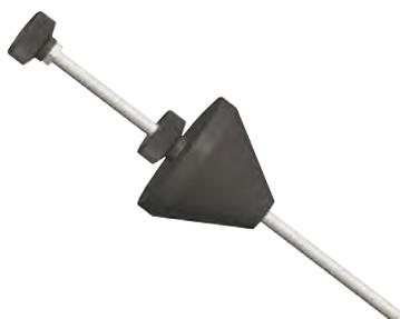
Der T330 Flanschadapter ermöglicht eine Montage des T330 an einem Flansch auch in vertikaler Position. Der Adapter wird dabei durch eine Bohrung des Flansches geschoben und an der Unterseite des T330 arretiert. Die Fixierung in der Bohrung erfolgt durch einen Konus auf der Rückseite.
